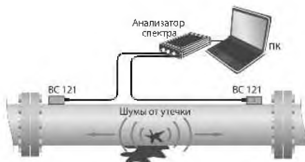
Обнаружение и локализация утечки коррелятором ZET 017 и датчиками BC 121
