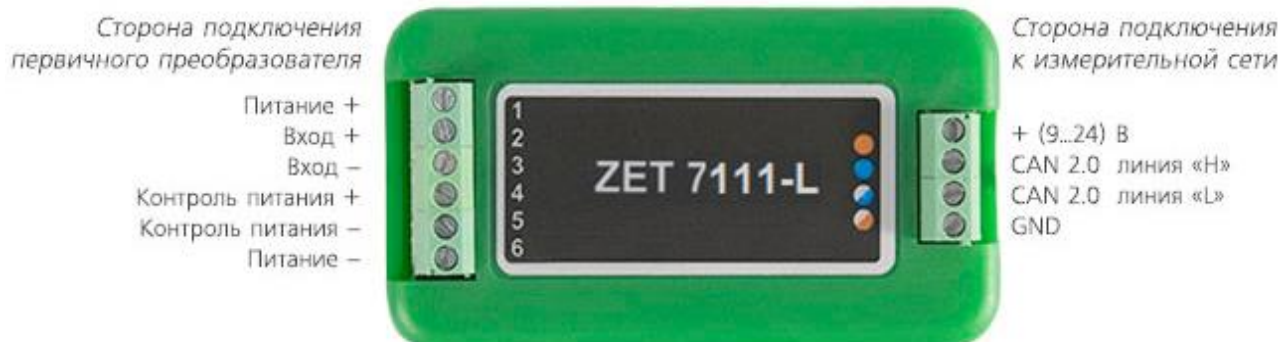
Рис. 2.3 Обозначении контактов ZET 7111-L в лабораторном исполнении
