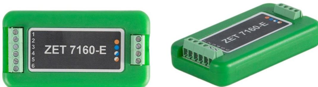
*Рис. 2.1 Внешний вид цифрового энкодера в лабораторном исполнении*
