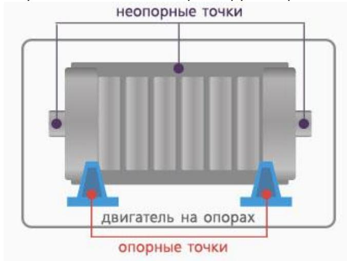
В программе устанавливают длительность испытаний и запускают требуемый режим работы изделия. На протяжении испытаний датчики регистрируют уровень вибрации и шума. По окончании испытаний рассчитываются усреднённые спектры сигналов с датчиков и строится профиль изделия по уровню вибрации и шума.
