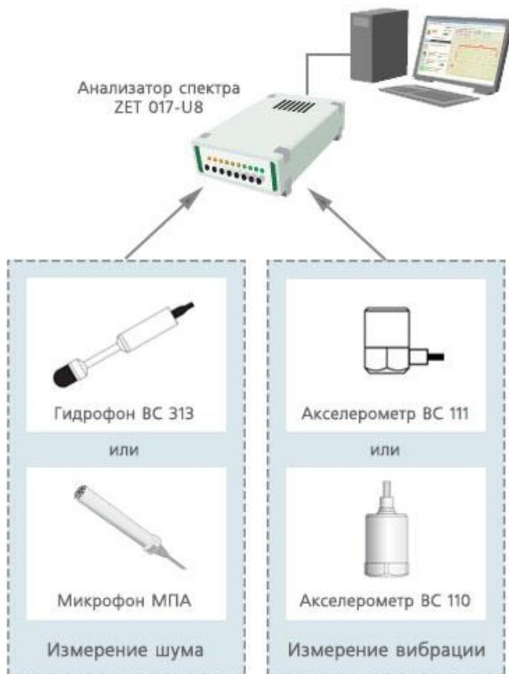
МКШС предназначена для определения передаваемой вибрации и акустического шума испытываемого изделия на корпус судна или сооружения. Вибрация может передаваться как через опоры или места крепления (опорные связи), так и через кабели, шланги, кожухи и пр. (неопорные связи).
