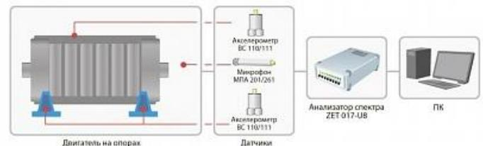
Автоматизированный комплекс «МКШС» предназначен для измерения и нормирования уровней вибрации и уровней шума при проведении стендовых виброшумовых испытаний различных изделий на соответствие техническим требованиям. Измерения проводятся в соответствии с требованиями методик контроля и нормирования шума и вибрации МКШС-81.
