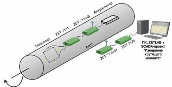
Система измерения крутящего момента предназначена для проведения периодических и ресурсных испытаний различных движущих элементов конструкций, например лопастей турбин, вертолетов. Система позволяет измерять проводить испытания как в статике (измерения крутящего момента), так и в динамике (измерение неустойчивости крутящего момента).
