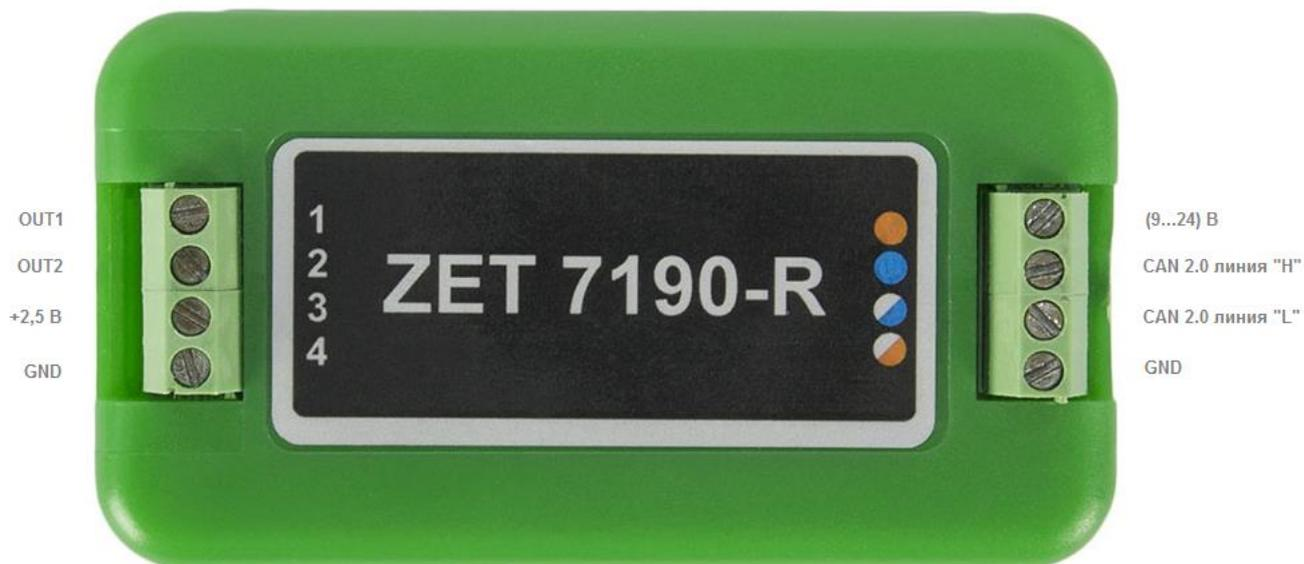
Рис. 2.3 Обозначение контактов ZET 7190-R в лабораторном исполнении
