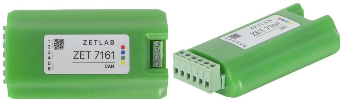
Рис. 2.1 Внешний вид управляющего модуля в лабораторном исполнении
