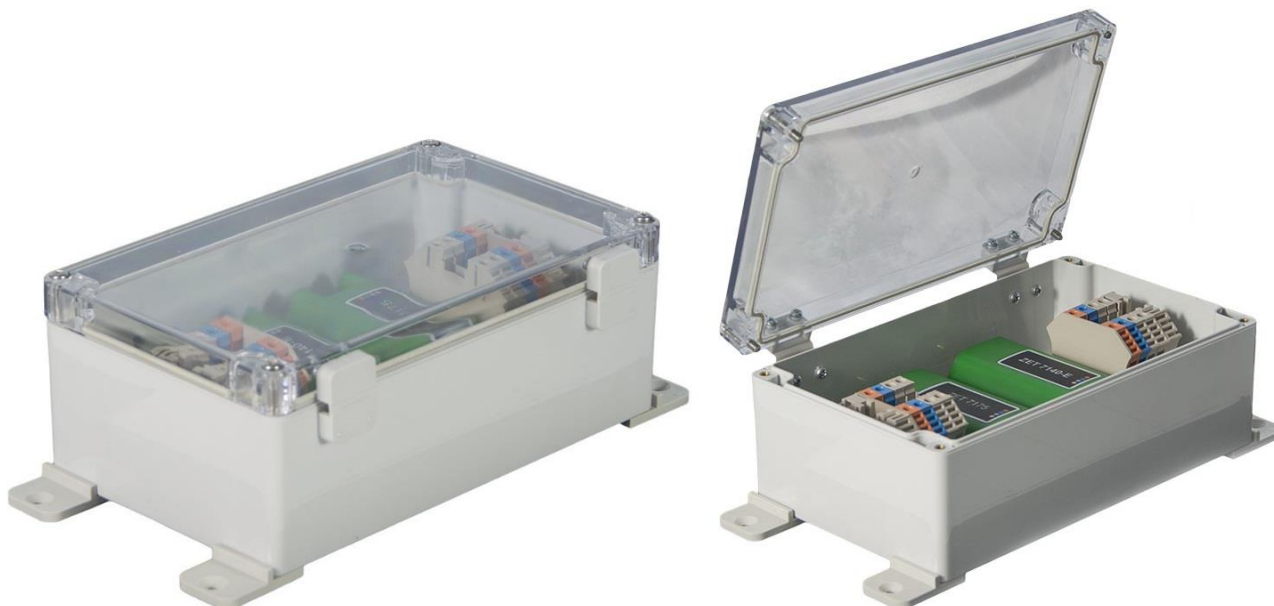
Рис. 2.2 Внешний вид управляющего модуля в промышленном исполнении
