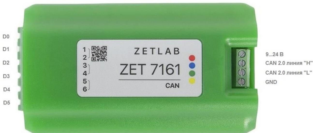
Рис. 2.3 Обозначения клемм ZET 7161 в лабораторном исполнении
