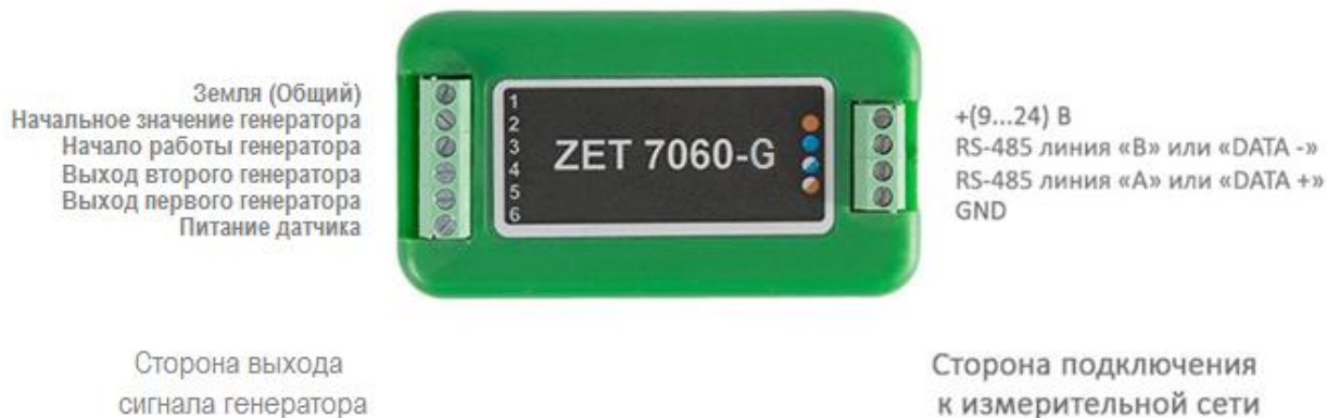
Рис. 2.3 Обозначение клемм ZET 7060-G в лабораторном исполнении
