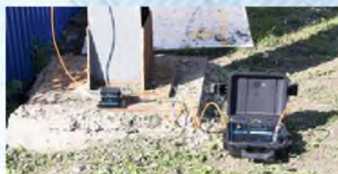
Датчик крепится с помощью магнитов
