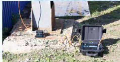
При одновременном применении нескольких регистраторов можно создавать распределенные системы сбора данных и мониторинга несущих конструкций мостов.
