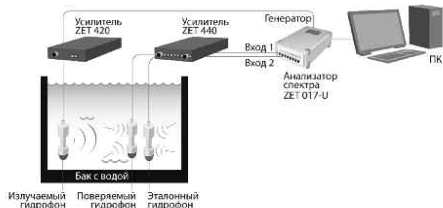
Структурная схема стенда поверки гидрофонов в воде.
