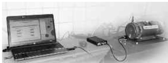
Стенд балансировки роторов
